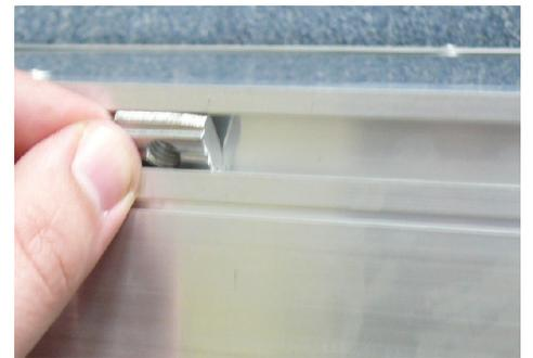
Abb. 2: Einschwenken des Nutensteins
